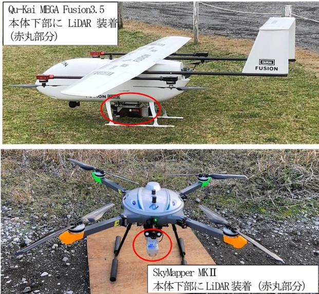
図-3 使用した無人航空機2機種（上段がVTOL固定翼型、下段がマルチコプター型であり、双方機体下部にLiDAR装着済）
