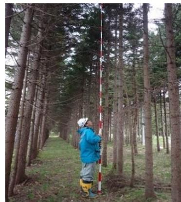
写真-1 検測桿による樹高計測の様子
