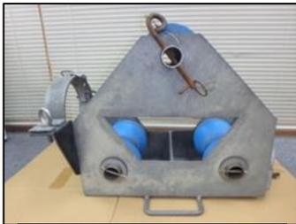
写真2 鋼製スレーパー
