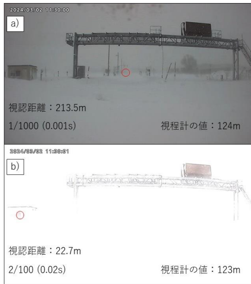
図-6 CCTVカメラBで撮影された画像。a)露光時間0.001秒、b)露光時間0.02秒
