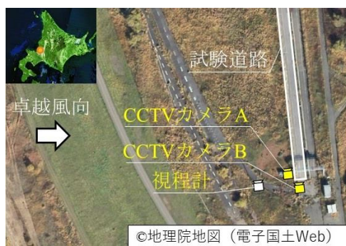
図-4 石狩吹雪実験場のCCTVカメラと視程計の配置
