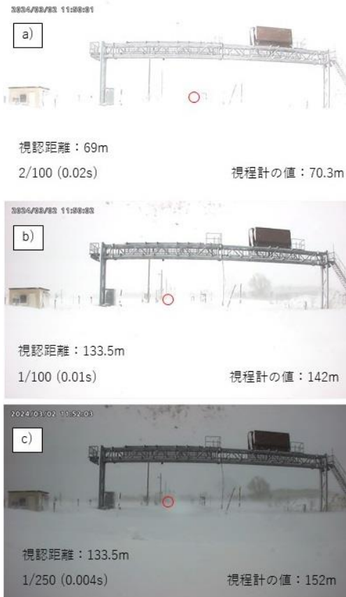
図-7 露光時間の違いによる CCTV カメラ B の視野。露光時間はそれぞれ a)0.02秒、b)0.01秒、c)0.004秒である。赤丸は視認距離に用いた箇所である。
