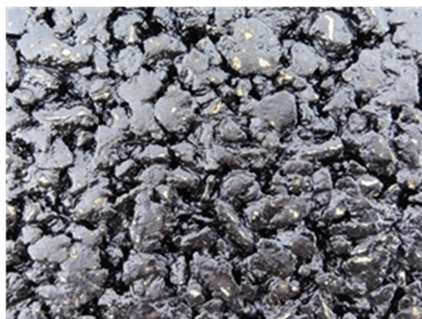
写真4 路面状況（ポリマー改質アスファルトH型）
