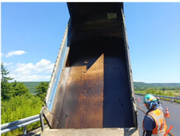
写真-2 ダレ確認（ポリマー改質アスファルト H型-F）
