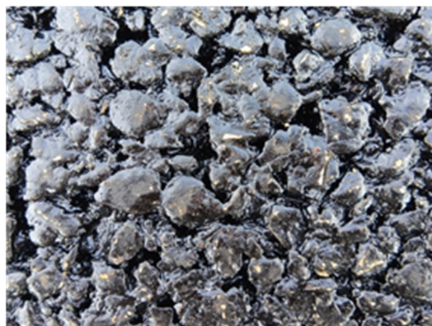
写真5 路面状況（ポリマー改質アスファルトH型-F）
