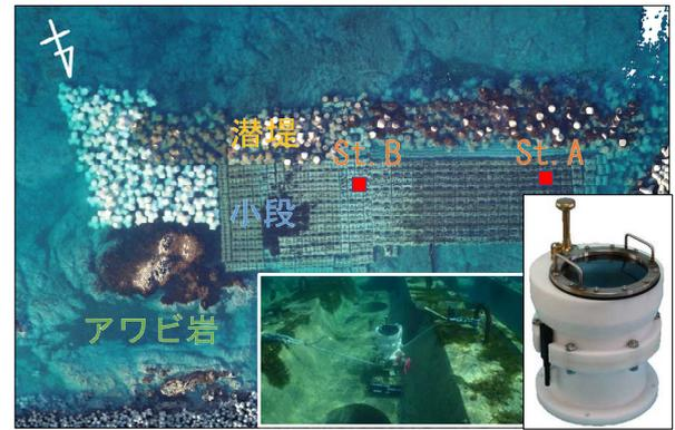
図3.2 流速観測機器の形状・設置位置
