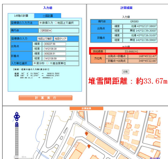
図-6 GNSS計測結果から算出した堆雪間距離 8)
