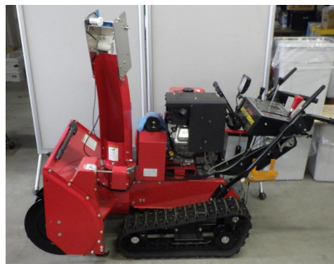
写真-4 ハンドガイド除雪機 (計測装置取付状態)
