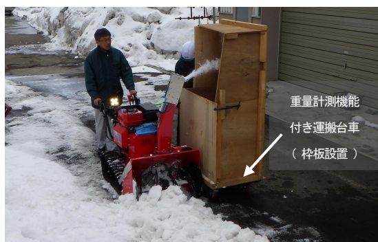
写真-5 排雪重量計測試験状況
