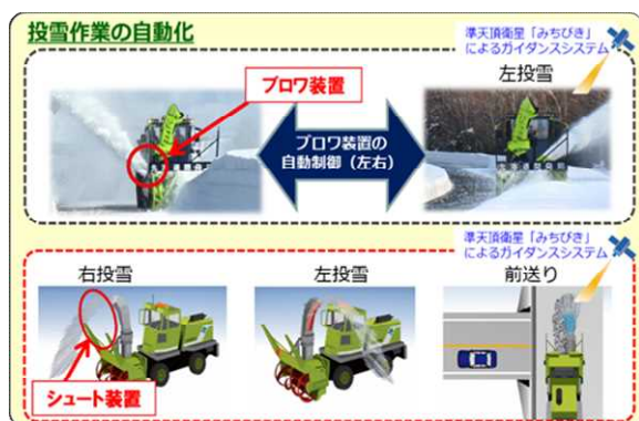
図-4 ロータリ除雪車投雪作業の自動化
