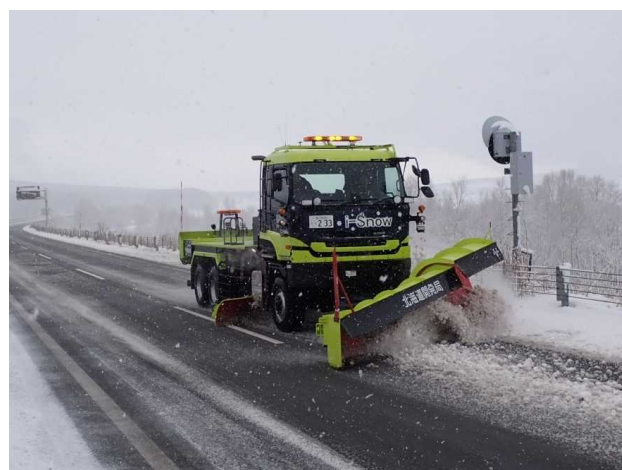
写真-2 高規格道路用除雪トラック「4.5m級」
