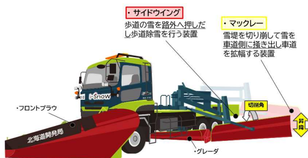
図-14 サイドウィング装置やマックレ装置の自動化検討
