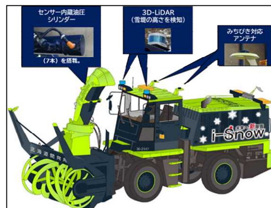
図-6 自動化に関する設置機器
