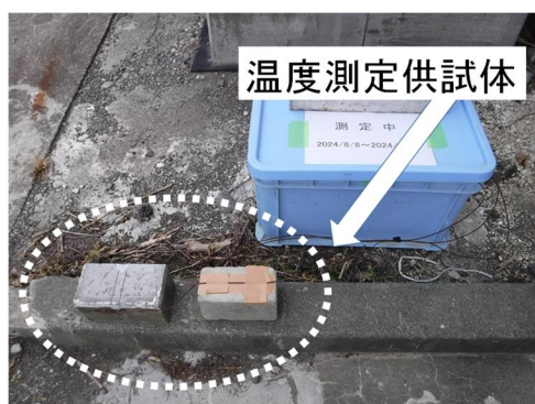
写真-6 コンクリートの温度測定状況 (測定期間：2024年8月8日～9月9日)
