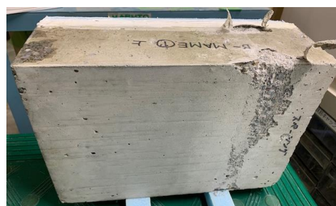
写真-1 凍結融解 75 サイクル時点の豆板供試体の変状
