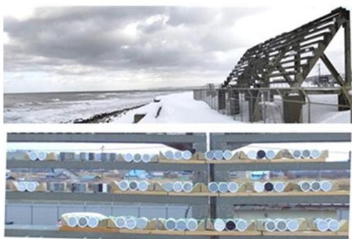
図-3 増毛暴露実験場の暴露状況
