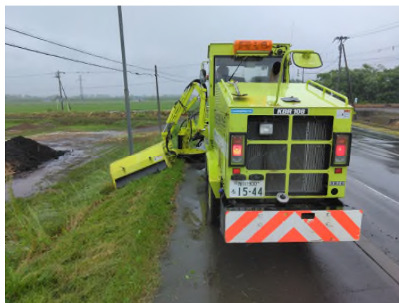
写真-2 小形除雪車(草刈り装置付)による機械除草作業
