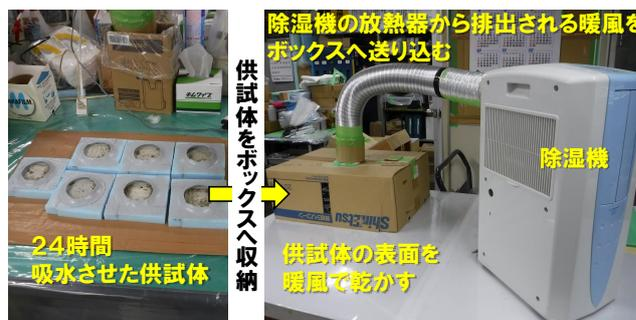
写真-5 吸水後の供試体に暖風をあてている様子（室内実験）
