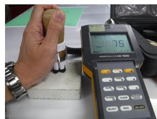
写真-6 電気抵抗式水分計による測定の様子（室内実験）
