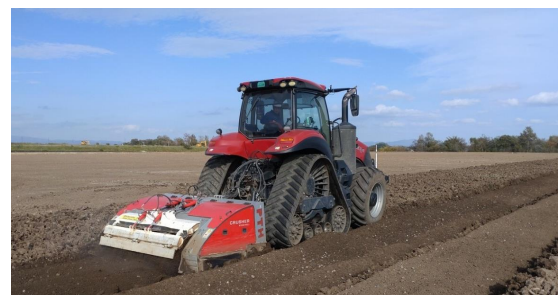
図-5 ストーンクラッシャーの破碎状況
