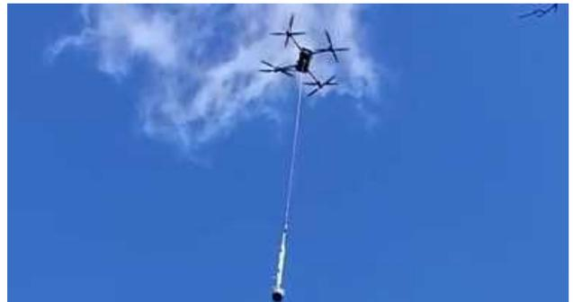
写真-5 空中線を輸送するドローン
