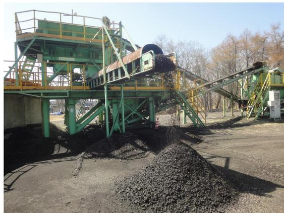
写真-2 アスファルト再生骨材 40mm級(一次分別材)
