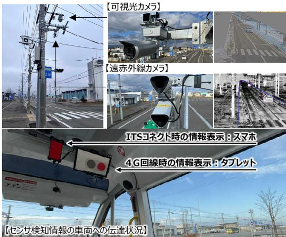
図4 機器の設置状況及びオペレータへの情報提供手法
