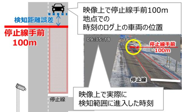
図-8 検知距離誤差の算出方法
