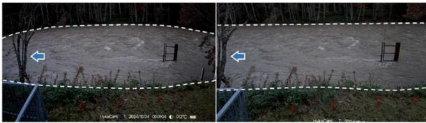
図-7 トレイルカメラ歪み補正 (左:補正前 右:補正後)
