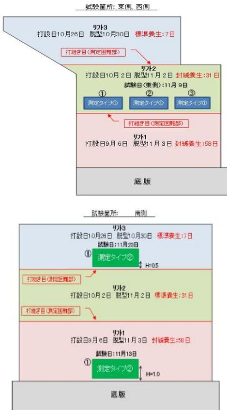
図-2 打設・養生スケジュールと品質評価測定箇所 (紋別川橋)
