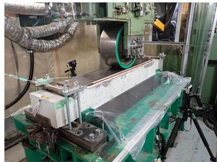
写真-2 小型輪荷重走行試験機
