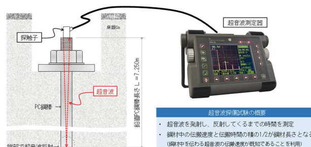
図-5 超音波探傷試験の概要
