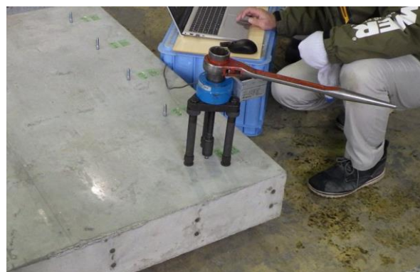
写真-4 アンカー引抜試験の様子
