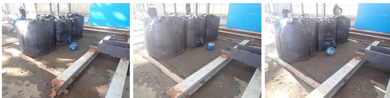
(a)落下高さ 4m で 5 回目の衝突後
