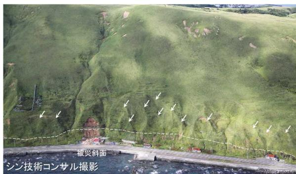
写真3 周氷河斜面の末端に並ぶ過去の崩壊地形（白矢印）。白破線は段丘面の基底
