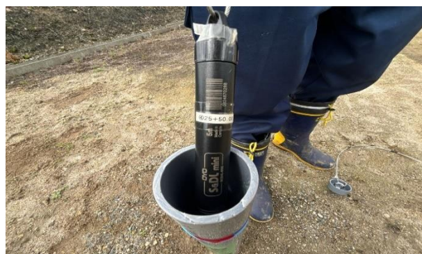
写真-9 絶対圧水位計
