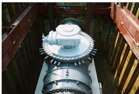
写真-4 インサーバタフライ弁の例 (メーカーホームページより)
