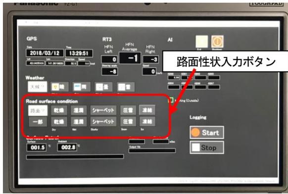
図-4 計測車両内の路面性状等入力画面
