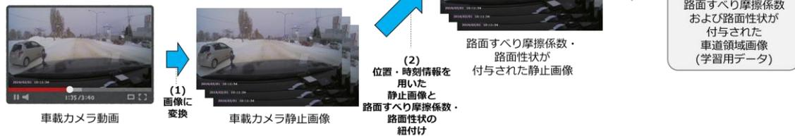
図-3 路面すべり推定AIおよび路面性状推定AIの学習用データ生成方法の概要
