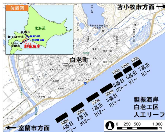
図-1 白老工区の人工リーフ配置・施工年度
