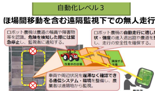
図-17 遠隔監視制御下での走行試験
