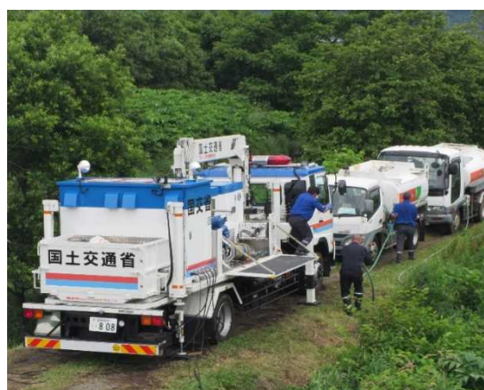
写真-4 給油を受ける災害用排水ポンプ車
