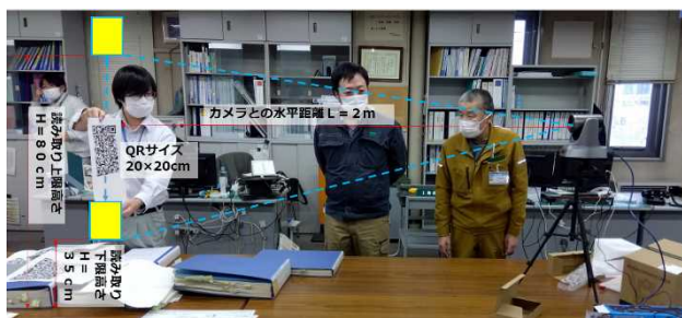
写真-7 AIカメラによるQRコード読み取り感度テスト
