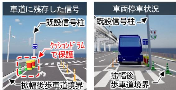
図-6 信号柱移設が遅延した場合の措置計画
