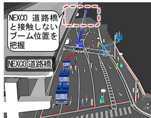
図-9 クレーン等工事用車両の配置計画(前方)
