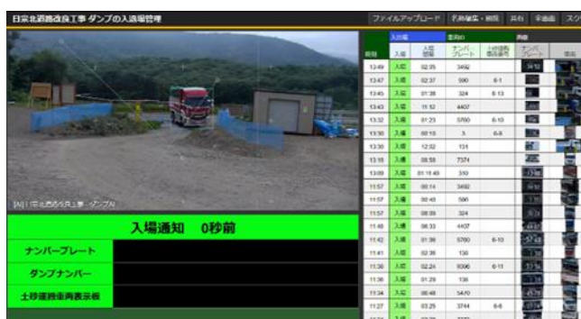
写真-2 ダンプトラック現場内入場時モニター画像
