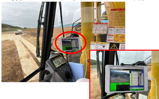
写真-3 重機キャビン内モニター設置状況
