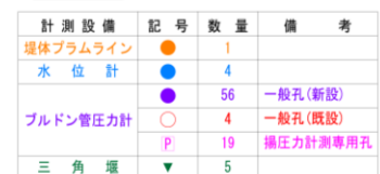
区分 項目 数量 計測手法 計測頻度 漏水量 全漏水量 5箇所 三角堰 1回/日 基礎排水量 既設：4箇所 メスシリンダー 1回/日 新設：56箇所 メスシリンダー 1回/日 揚圧力 － 既設：4箇所 ブルドン管圧力計 (基礎排水孔) 1回/日 新設：56箇所 ブルドン管圧力計 (基礎排水孔) 1回/日 19箇所 ブルドン管圧力計 (揚圧力専用孔) 1回/日 変形量 堤体変位量 1箇所 ブラムライン 1回/日
