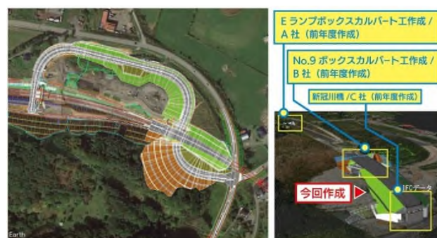
図-5 前年度作成の3次元モデルを活用し構造物位置確認
