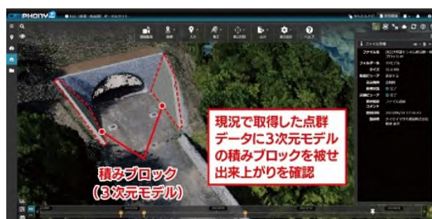
図-4 現況データと構造物の配置確認
