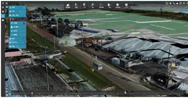
図-9 3次元モデルの配置による片側交互通行規制確認
