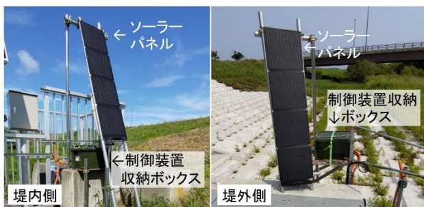
写真-1 現地試験におけるシステム設置状況（厚別川）
