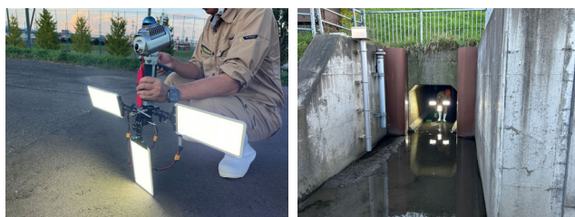
写真-5 ハンディ LiDAR（左）と調査状況（右）
