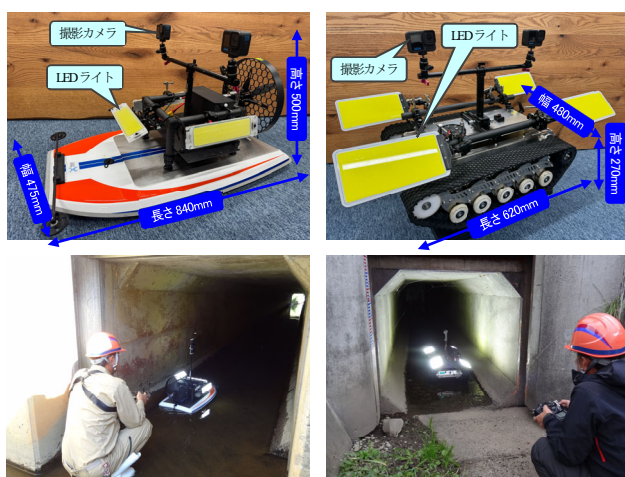
写真-2 機材、調査状況（左：ボート、右：キャタピラ）
