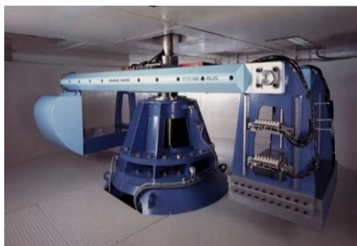
図-1 遠心力実験装置
