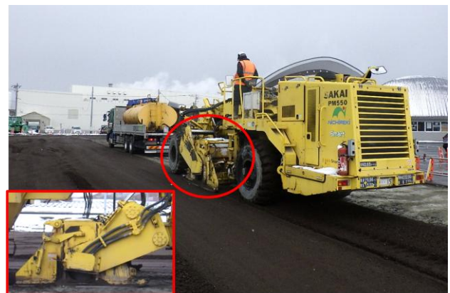
写真-2 ロードスタビライザ（拡大：作業装置）
