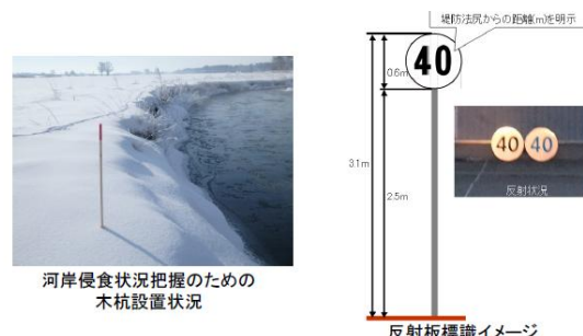
図-15 河道変化モニタリングの強化（反射板・木杭）
