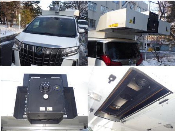
図-9 MMS 車両（左上：車両前方、右上：車両後方、下：車両後方の計測装置）
