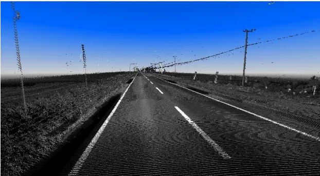
図-2 MMS 車両の計測による 3次元点群データの取得
