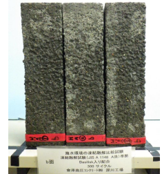
写真-5 凍結融解試験状況（左）試験供試体（右）
