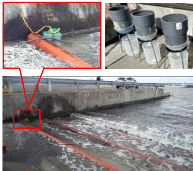
写真-3 供試体暴露試験：干満帯と透水試験（右上）
