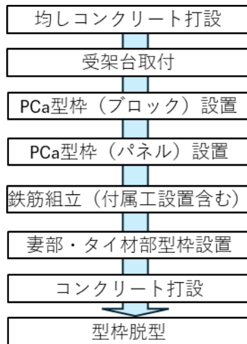
図-4 PCa 型枠による上部工の施工フロー
