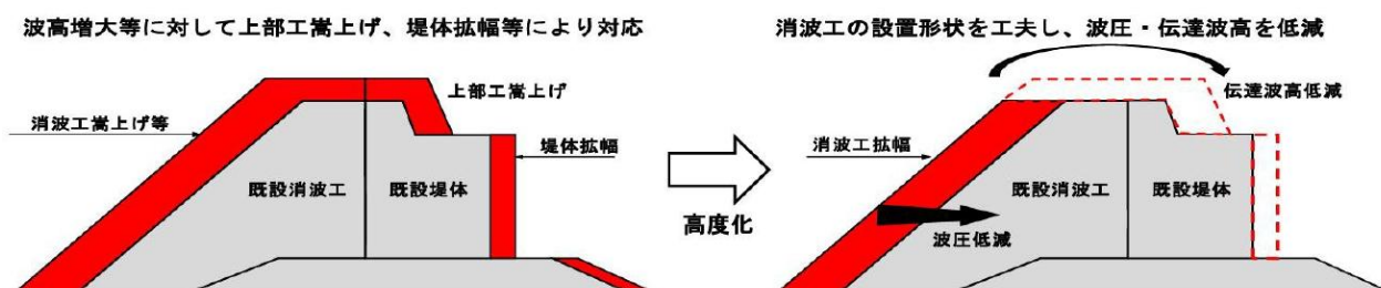
図-1 消波ブロック被覆堤の改良方法(左:従来の改良方法 右:消波工の拡幅による改良方法)
