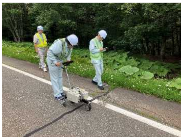
図-2 MRPによる路面の縦断測定の様子
