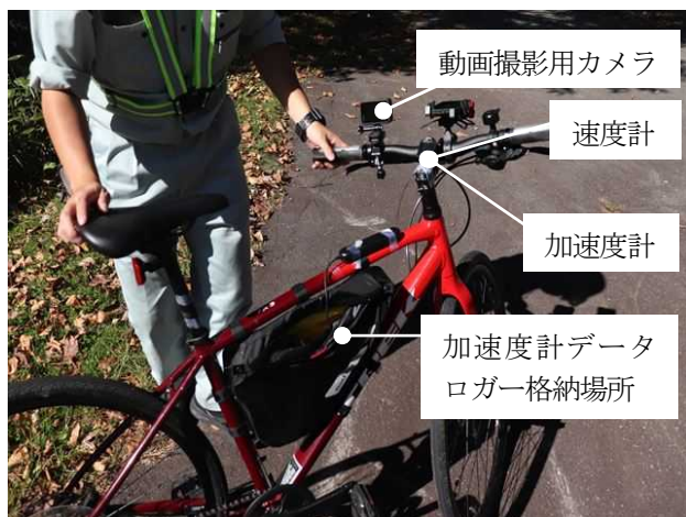
図-4 自転車に取りつけた各種の測定機器
