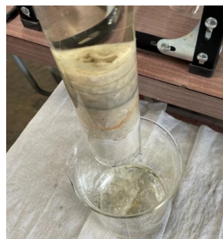
写真-2 室内での通水実験の状況（アクリル管内の植物繊維）
