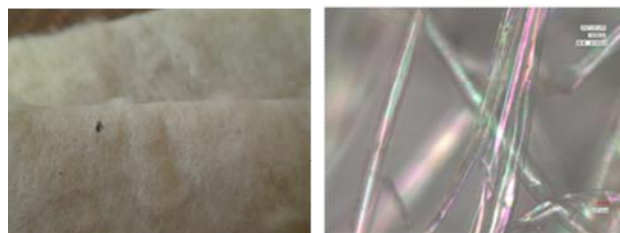
写真-1 浄化実験で使用する植物繊維(カポック)
