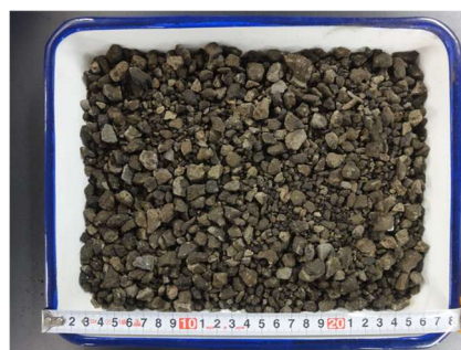
写真-1 試験盛土に使用したアスファルト再生骨材 13mm 級
