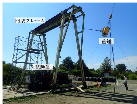
写真-5 振り子式の重錘衝突実験
